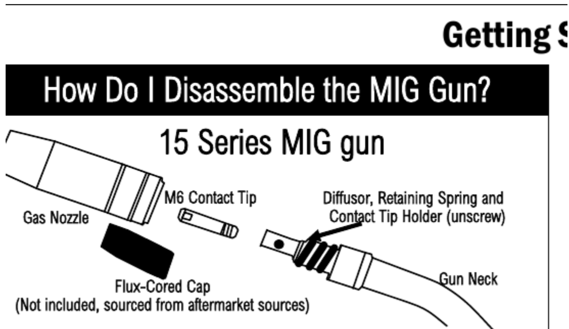
Figura 8. Desarmado de la pistola MIG: serie 15 (arriba) y series 24/36 (abajo). Siempre retire e instale la tobera de gas de la serie 15 girando en sentido horario.
