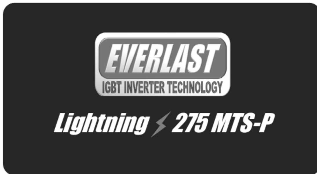
Figura 18. Pantalla de arranque (boot-up). Durante el arranque puede oír clics, golpeteos o "thumps" al conmutar relés y solenoides; esto es normal y también se oye al cambiar de proceso o seleccionar ciertas funciones.
